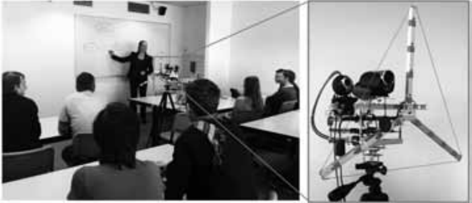
Abbildung 3: Der Prototyp zur automatischen Kamerasteuerung im Einsatz während einer Lehrveranstaltung.
