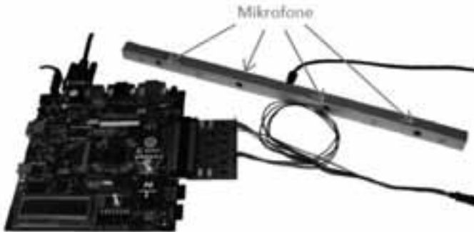
Abbildung 2: Spartan3E-FPGA und Mikrofonarray mit vier Einzelmikrofonen
