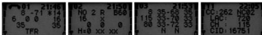
Abbildung 2: Der Netzmonitor im Menü eines Nokia 3310 mit Informationen zu den einzelnen empfangenen Basisstationen.
