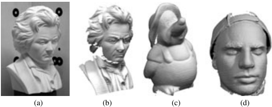
Abbildung 3: (a) Kamerabild einer Beethovenbüste; (b) gescannte Oberfläche künstlich beleuchtet; (c) 3d Scan einer Tonfigur; (d) 3d Scan meines Kollegen Sven Molkenstruck.
