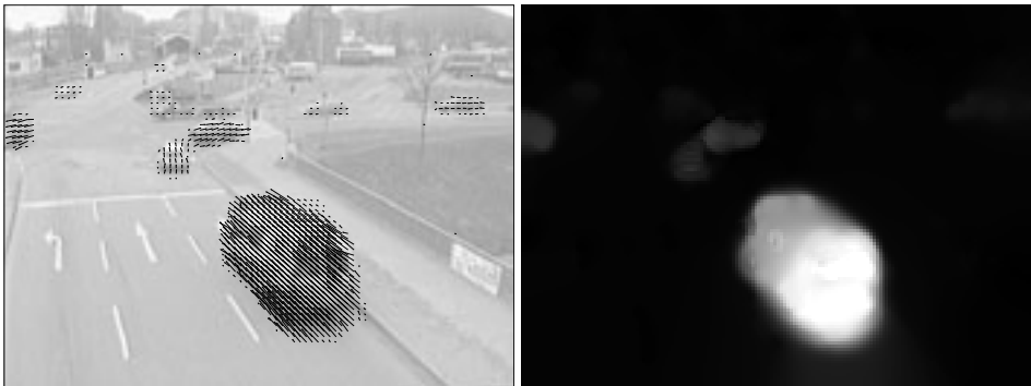
Abbildung 4: Ergebnis der Echtzeitberechnung für die Rheinhafen-Sequenz [IKS]. Links: Bild 1130 mit überlagertem Verschiebungsvektorfeld. Rechts: Betrag des Verschiebungsvektorfelds.
