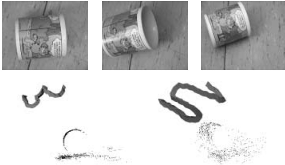
Abbildung 2: Die Bilder 0, 50, und 250 einer typischen Bildsequenz (obere Reihe), sowie das Ergebnis der Kamerakalibrierung (untere Reihe). Die Aufnahmepositionen sind als kleine sich gegenseitig überlappende Pyramiden visualisiert. Die schwarzen Punkte zeigen rekonstruierte Punkte der Szenenoberfläche.
