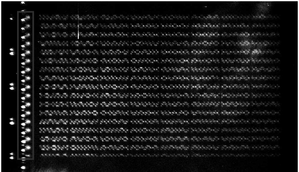
Abb. 1: Optisches Emmissions-Bild der AES-S-Box, gespeichert im SRAM eines ATmega328P-Mikrocontrollers der Firma Atmel. Die 256 Bytes der S-Box sind in 32 Speicherzeilen mit je 8 Bytes gespeichert. Die Emissionen der Zeilentreiber, die links der entsprechenden Speicherzeilen im roten Rechteck zu sehen sind, sind deutlich sichtbar und ermöglichen die sogenannte Simple Photonic Emission Analysis .
